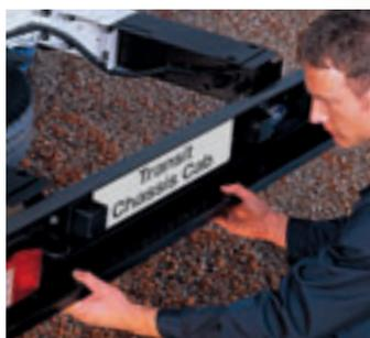
La barra posteriore paraincastro rimovibile facilita la realizzazione di allestimenti specifici.
